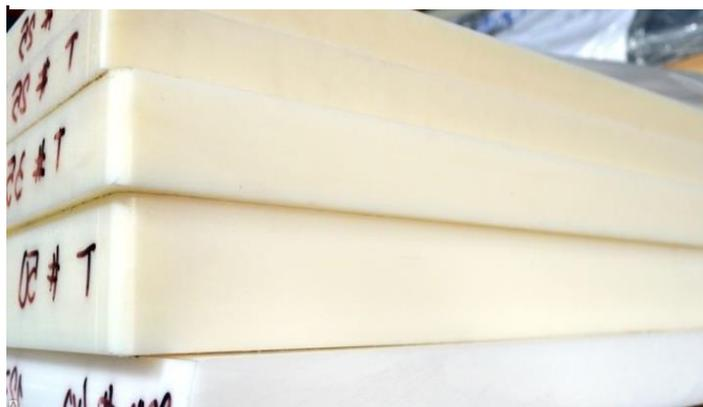
Капролон - высокотехнологичный конструкционный полимер, по своим техническим характеристикам не уступающий металлу. Этот инновационный полимерный материал используется для изготовления подшипников и других деталей, подвергающихся трению в процессе эксплуатации. У аналога металла есть несколько серьезных преимуществ, определяющих растущий спрос на полимерную продукцию:
