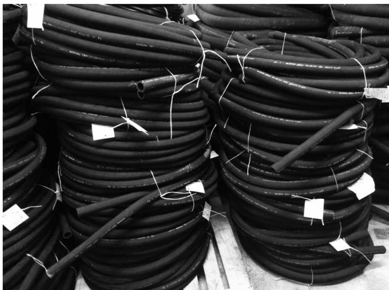
Маслобензостойкие рукава (МБС) широко применяются в нефтяной, автомобильной, газовой, топливной промышленности, народном хозяйстве и других сферах где по шлангу протекают такие жидкости как :
